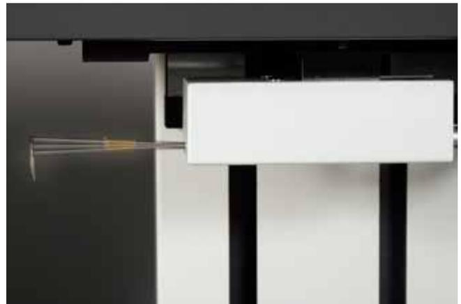
ハイブリッド検出器は、表面粗さ、輪郭形状を一回の測定で、評価・解析・印字まで簡単に自動実行が可能です。
