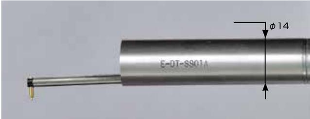
サーフコム 2000DX3/SD3 には、粗さ専用検出器の追加が可能です。粗さ測定での測定範囲 1000 μm を実現、測定倍率最大 50 万倍で解析可能です。また、粗さレベルの微細な輪郭形状評価にも有効です。
